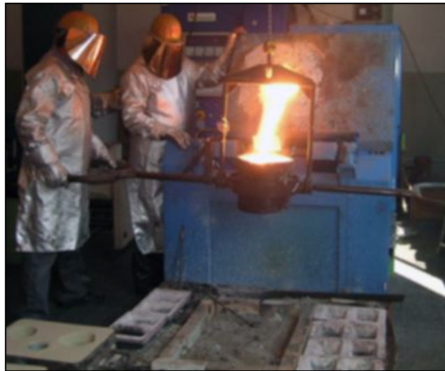
Abstich eines Induktionsofens (Quelle: Dr. Behm (IFQ))
