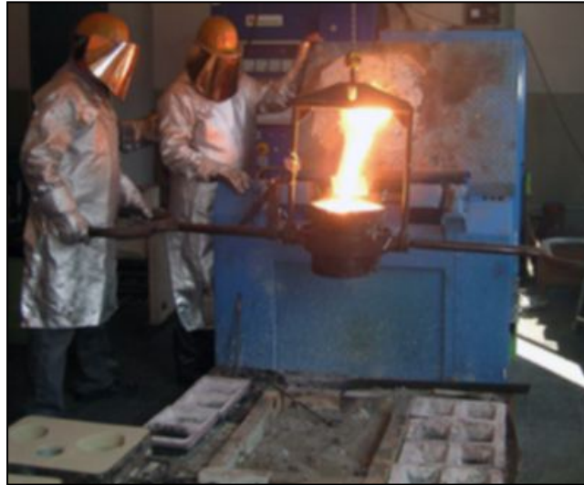
Abstich eines Induktionsofens (Quelle: Dr. Behm (FQ))
